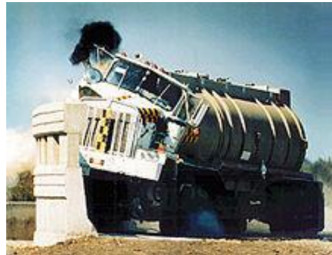
Variante con remate estético sobreelevado de 2290mm redireccionando camión cisterna con 36.000kg de gasolina.
